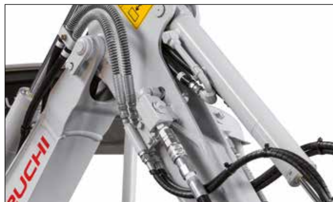
3 circuitos hidráulicos, 1 de ellos dirigido por potenciómetros.
