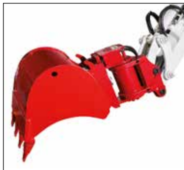
Powertilt con enganche rápido hidráulico, cazo montado al revés
