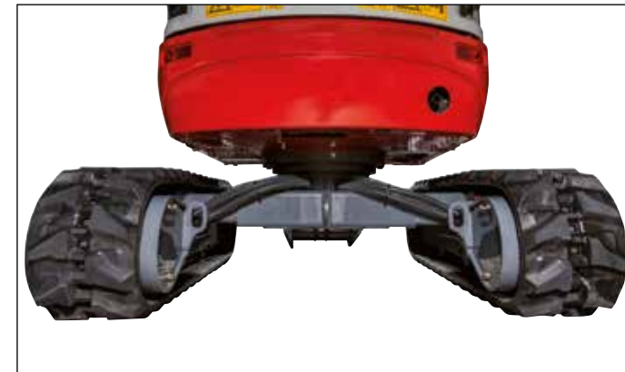
Gran distancia del eje al suelo, parte inferior del chasis cerrado y protegido.
