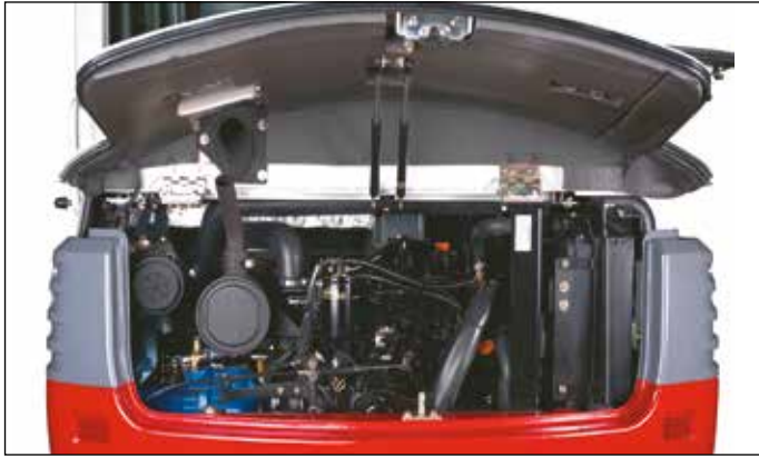
Motores con niveles reducidos de ruidos y emisiones de gases, compartimiento espacioso del motor, tubo de escape hacia arriba, contrapesos macizos.
