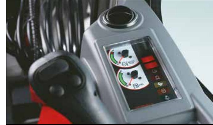
Panel de control con aviso acústico y visual en caso de fallo de funcionamiento.
