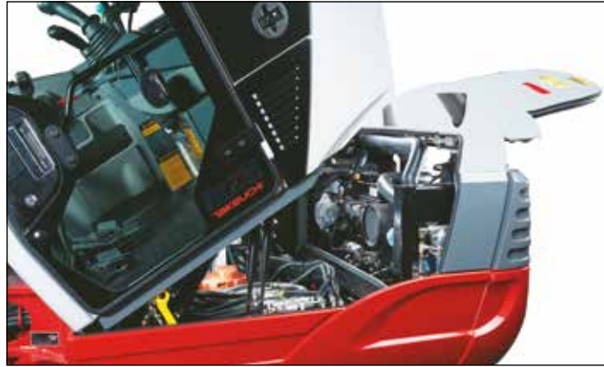
Cabina abatible con fácil acceso para el mantenimiento del motor y sistema hidráulico.
